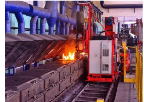
Automatic molten iron pouring
